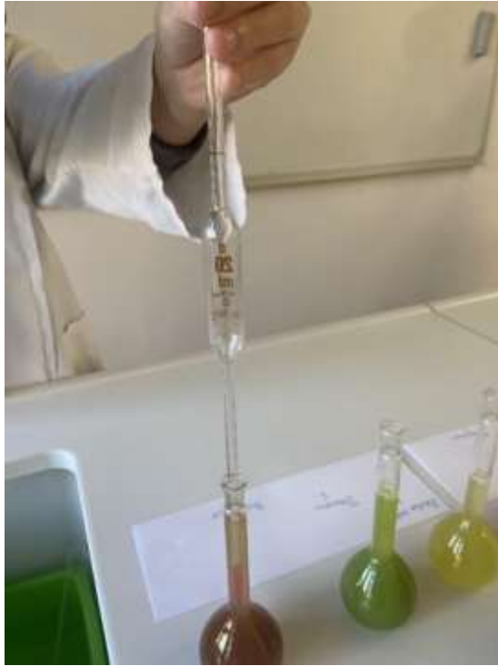
Slika 5: Pipetiranje vzorca z volumetrično pipeto (Vir: osebni arhiv)
