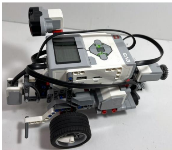
Slika 2: Robot, sestavljen s konstrukcijsko zbirko LEGO Mindstorms EV3 (Vir: Krajnc, Rojs, 2024)
