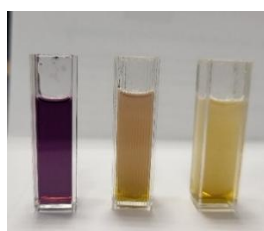
Slika 9. Sprememba barve DPPH po 400 sekundah (sredinska kiveta in po 10 minutah (skrajno desna kiveta) (lasten vir)
