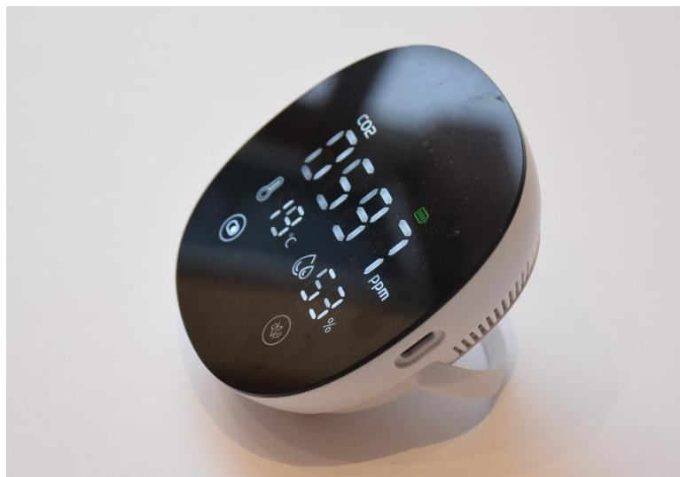
Slika 8: Merilec vrednosti CO 2 (foto: T. Sovič).
