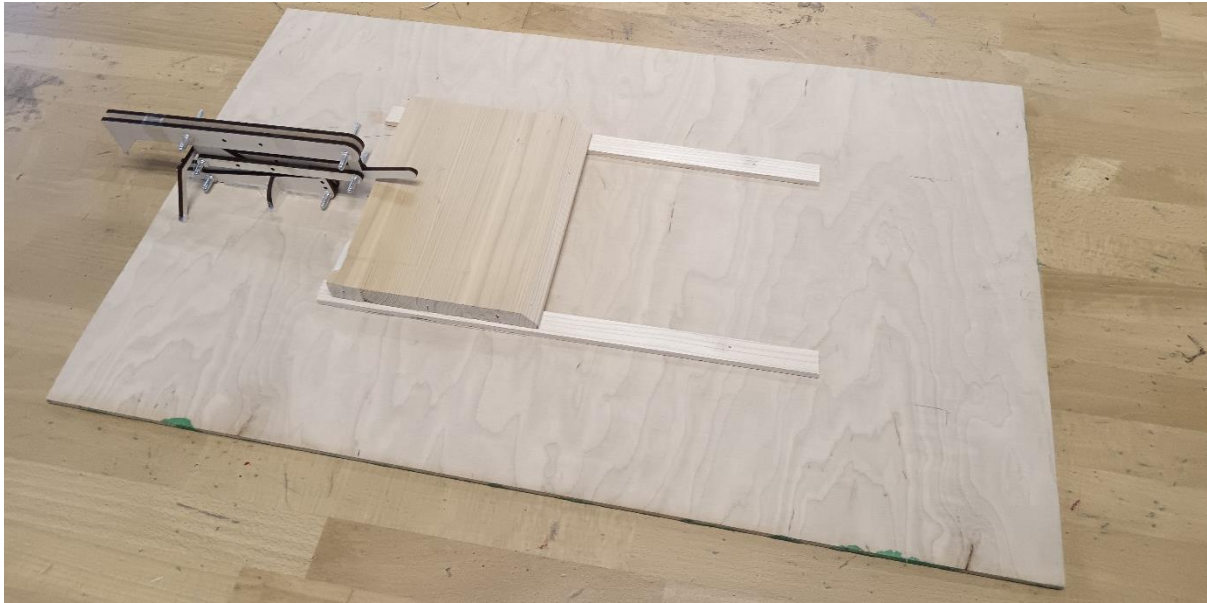
Slika 9: Lesena deska z napravo za meritve (levo) in desko za simuliranje talnega učinka
