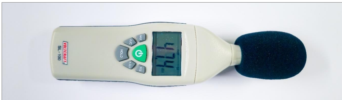
Slika 2: Merilnik jakosti zvoka, s katerim smo izvajale meritve
