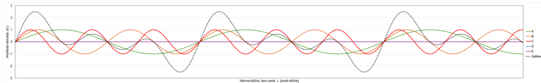
Slika 7: Troje različnih valovanj brez faznega zamika ter njihov seštevek – interferenca (vir: Lasten)
