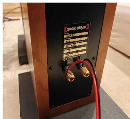
Slika 18: Obrnjena priključitev zvočnika, + → - in - → + (vir: lastni arhiv)
