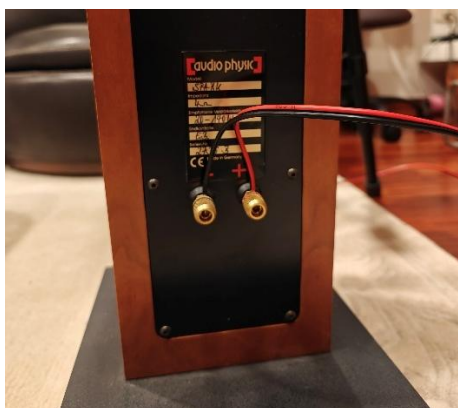
Slika 17: Pravilna priključitev zvočnika, + → + in - → - (vir: lastni arhiv)
