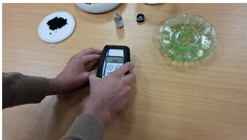
Slika 11: Merjenje ionizirajočega sevanja radijeve ure
