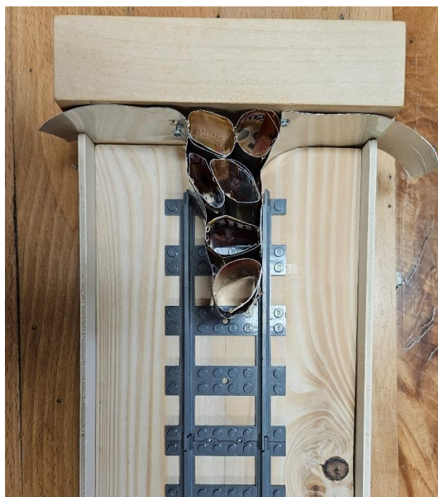
Slika 4: Model blažilnika trkov iz tanke pločevine (lasten vir).
