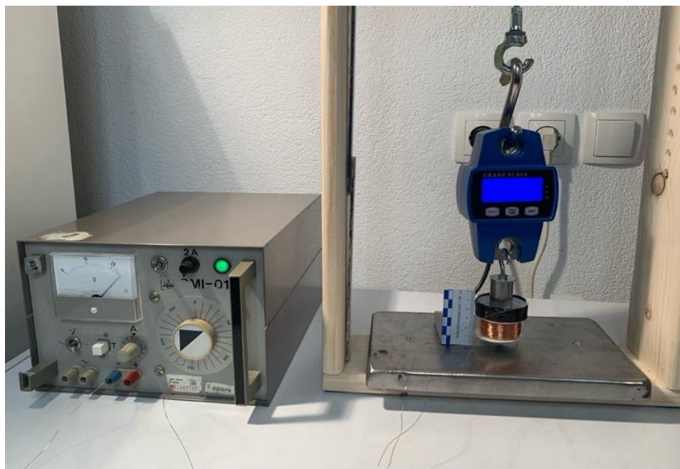
Slika 15: Merjenje magnetne sile elektromagneta na napetostnem viru
