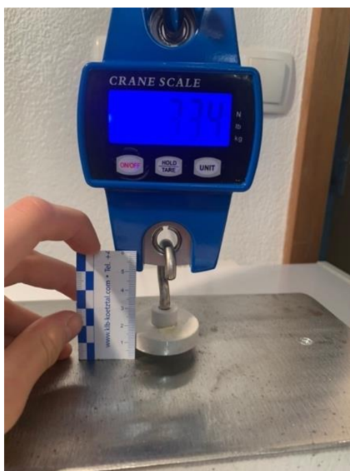
Slika 12: Merjenje magnetne sile in razdalje z neodšteto silo teže
