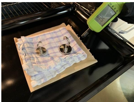
Slika 10: Segrevanje magnetov in merjenje temperature
