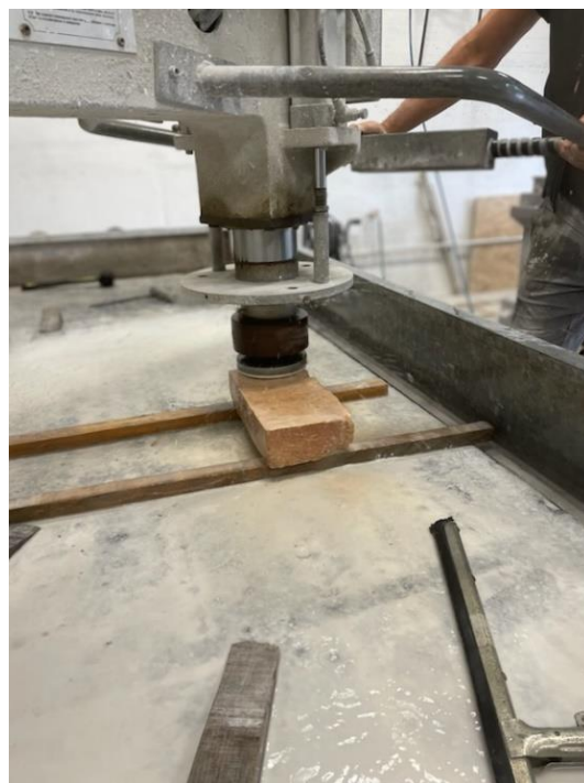
Slika 11: Brušenje opeke domače izdelave (Vir: lastna fotografija)
