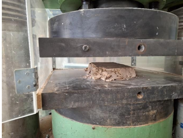
Slika 22: Pogled na preizkušane D po izvedeni tlačni preiskavi (Vir: Lastna fotografija)
