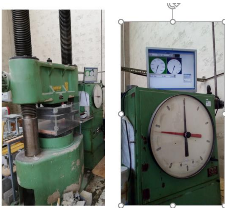
Slika 13: Preša za preverjanje tlačne trdnosti materialov in merilci obremenitve (Vir: lastna fotografija)
