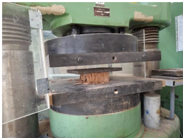
Slika 24: Pogled na preizkušane N po izvedeni tlačni preiskavi (Vir: Lastna fotografija)
