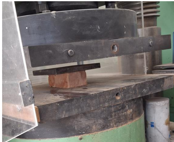
Slika 23: Pogled na preizkušane R po izvedeni tlačni preiskavi (Vir: Lastna fotografija)
