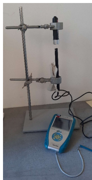
Slika 5: Prikazuje merjenje UVA sevanja umetne svetlobe z Vernier senzorjem (foto: Ž. Krebs).
