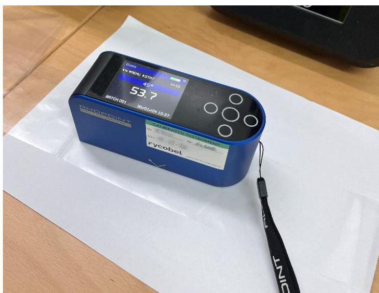
Slika 16: Merjenje sijaja z merilnikom GLOSSMETER 45°.
