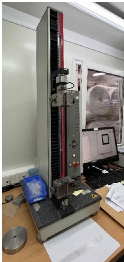
Slika 14: Natezni preizkus na napravi Zwicki Z1.0 TH.
