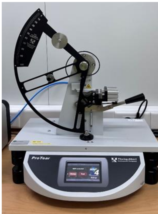
Slika 15: Naprava Elmendorf Tear Tester za preizkus trgalne trdnosti.
