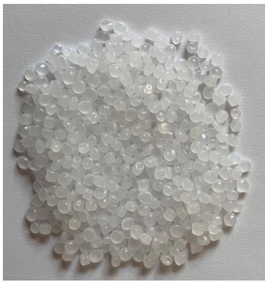
Slika 10: Primarni LDPE, uporabljen za izdelavo folij.
