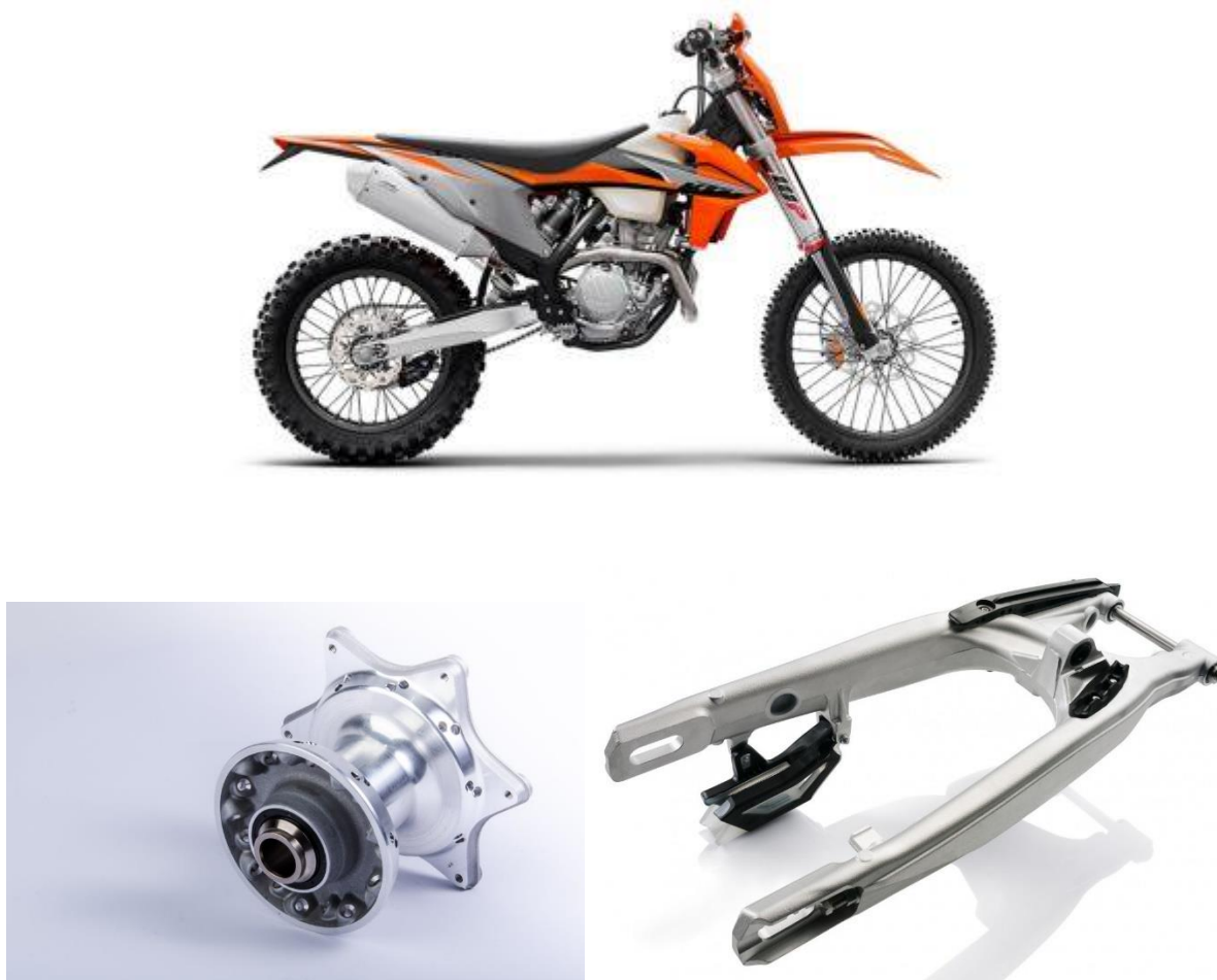
Slika 3. Uporaba livnih zlitin AlSi7Mg0.3 v motornih kolesih. Vgrajujejo se kot osi koles in vilice. Vir: KTM https://ktm.com in TALUM: https://talum-castings.si/
