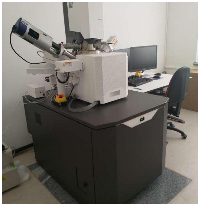
Slika 3: Vrščni elektronski mikroskop Thermo Fisher Scientific, model Quattro S (UL NTF)
