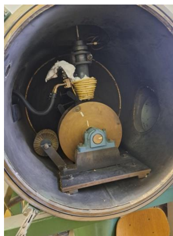
Slika 7: Naprava za hitro strjevanje na vrtečem se valju - Melt spinner
