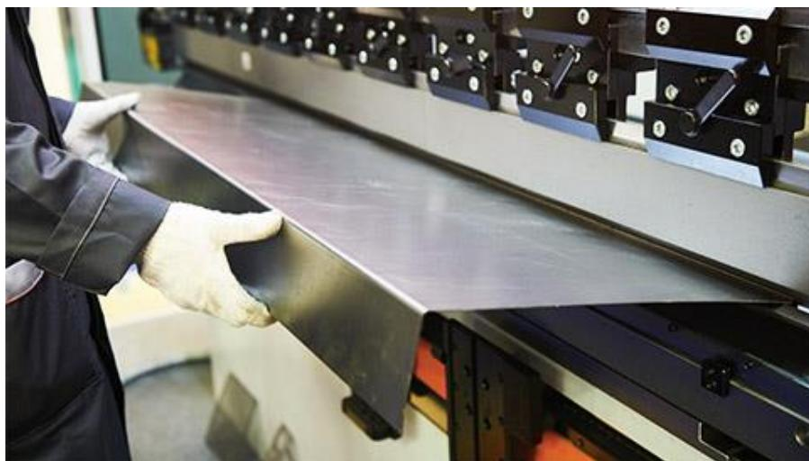
*Slika 25: Krivljenje pločevine [19]*
