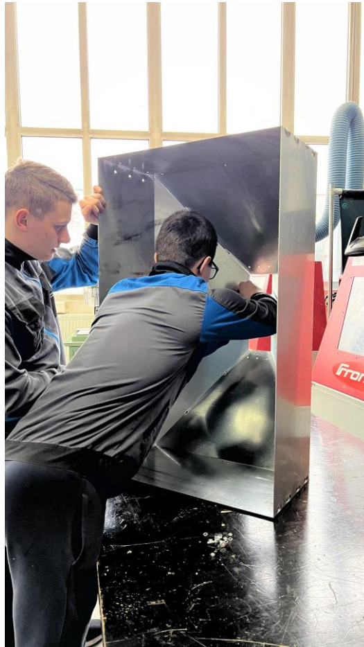
Slika 43: Sestavljanje zalogovnika in razdeljevalca
