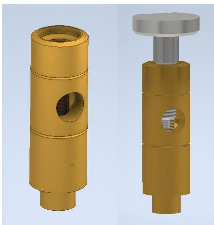
Slika 7: 3D model regulacijskega ventila
