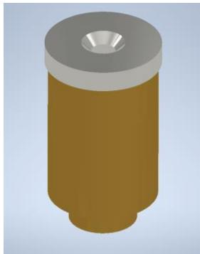
Slika 6: 3D model varnostnega ventila
