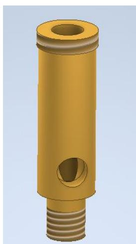
Slika 21: 3D model novega ventila
