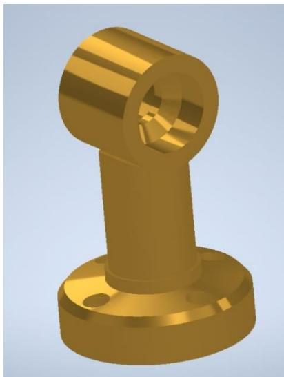
Slika 16: 3D model nosilca vztrajnika
