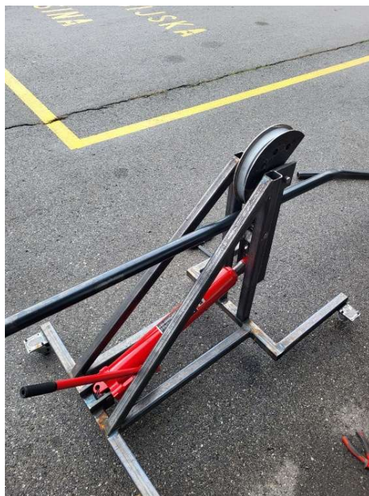
Slika 6.2: Doma izdelana krivilna priprava za krivljenje cevi.
