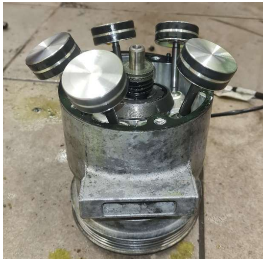
Slika 3.2: Razstavljen kompresor klime.
