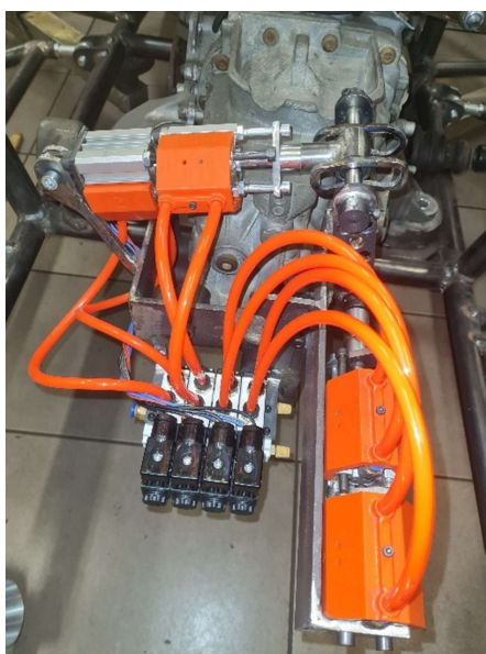
Slika 4.13: Končan prestavni modul II.
