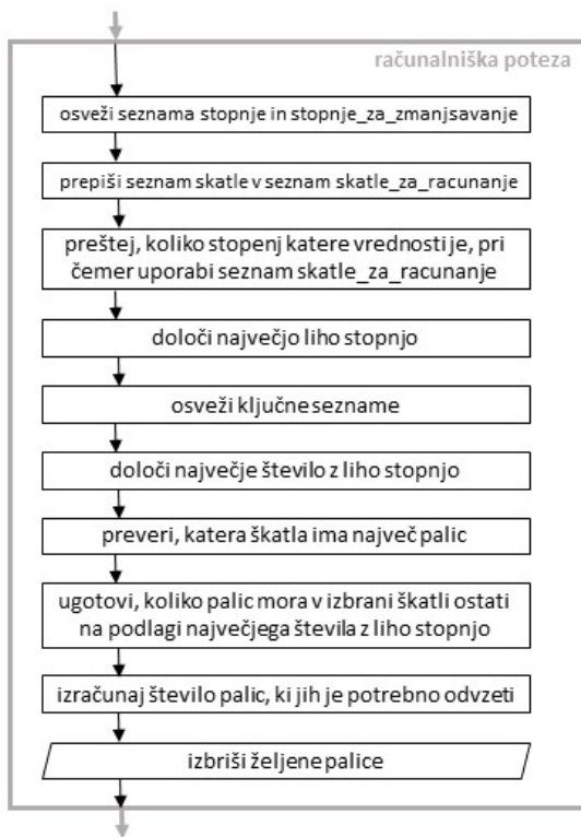
Slika 4: Diagram poteka delovanja poteze računalnika.
