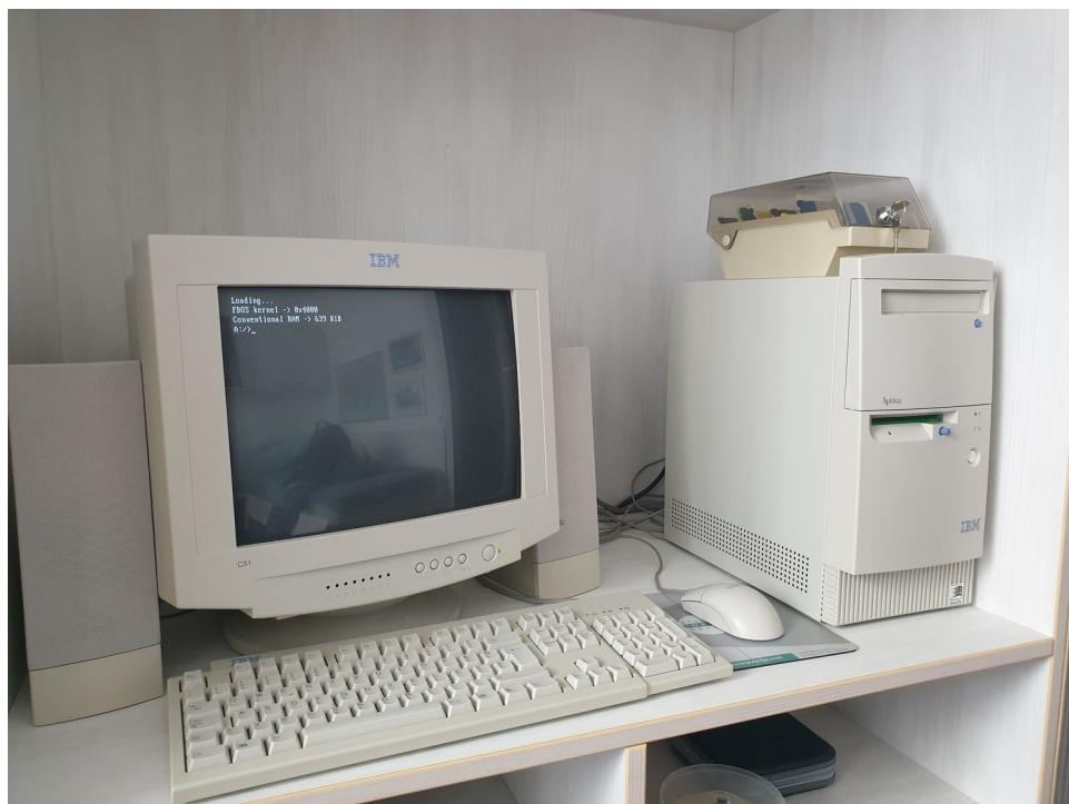
Slika 16: Računalnik IBM Aptiva, proizveden leta 1999. Poganja ga procesor AMD K6-2 500MHz in integrirana AGP grafika SiS 530.
