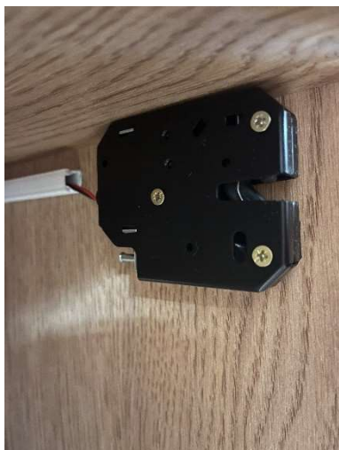
Slika 10: Montirana električna ključavnica
