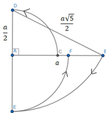
Slika 20: Konstrukcija zlate točke F s pomočjo krožnice in pravokotnega trikotnika.
