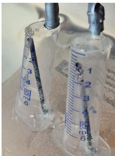
Slika 11: Nabiranje vodika (na desni) in kisika (na levi)
