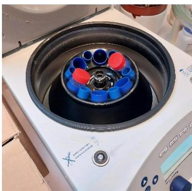
Naslednji dan smo nastale nanodelce v steklenički posedli s centrifugiranjem, jih nato dvakrat sprali z etanolom in dvakrat z vodo ter jih na koncu redispergirali v 10 ml vode.
