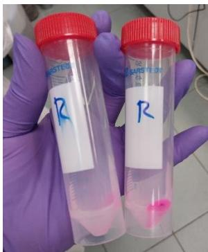
Naslednji dan smo nanodelce v steklenički posedli s centrifugiranjem, jih dvakrat sprali z etanolom in dvakrat z vodo ter jih na koncu redispergirali v 10 ml vode.
