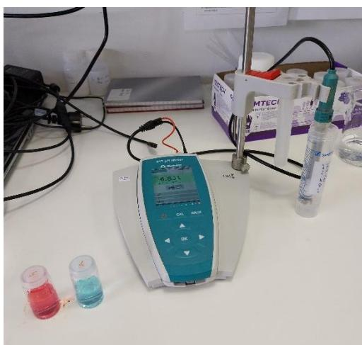
Slika 21: Merjenje pH vrednosti vzorca nanodelcev na aparaturi pH-meter 913 (Metrohm) (vir: Petra Ouček)
