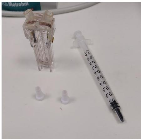
Slika 19: Pripromočki za pripravo vzorcev za analizo hidrodinamske velikosti delcev na aparaturi Litesizer 500 (Anton Paar) – kiveta Omega, čepki in brizga (vir: Petra Ouček)
