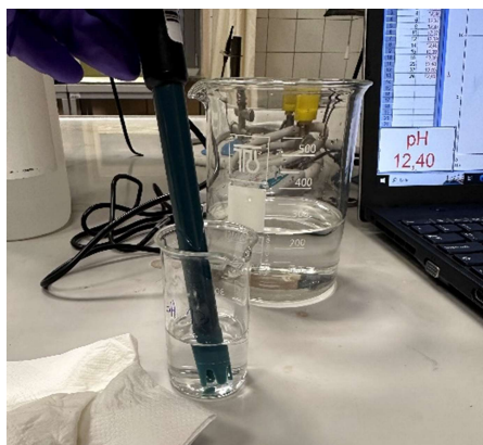
Slika 3: merjenje s pH metrom (lasten vir)
