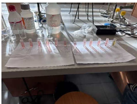
Slika 10: barve vodnega ekstrakta octovca pri različnih pH (lasten vir)
