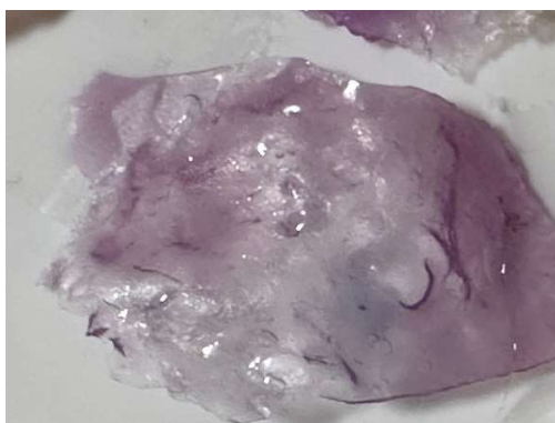
Slika 16: rezultat po enem dnevu na lističu iz škroba in indikatorjem iz rdečega zelja (lasten vir)
