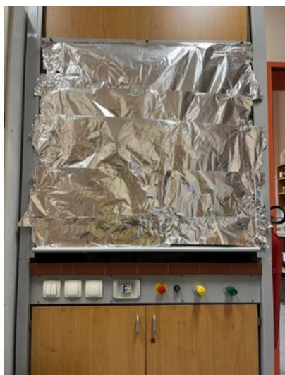
Slika 6: Zaščiten digestorij (lastni vir).
