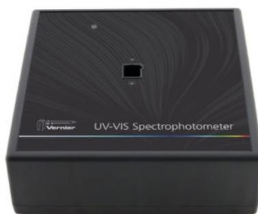
Slika 4: Vernier UV-VIS spektrofotometer (Vernier, 2019).
