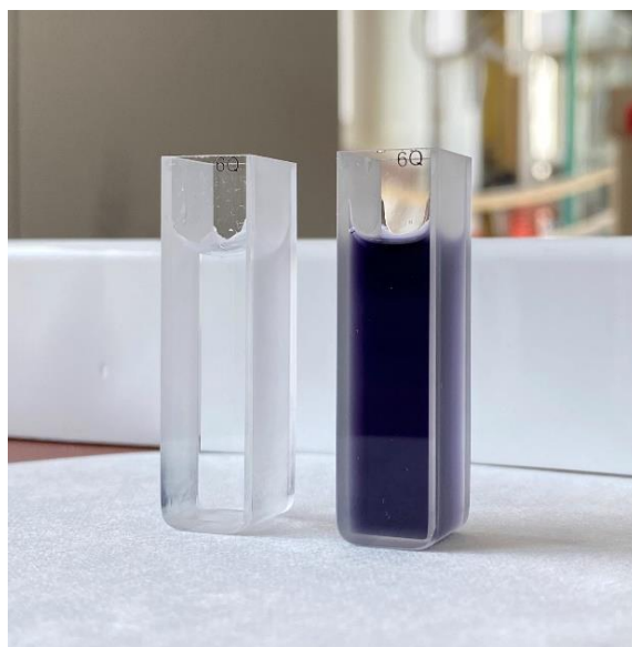
Slika 20: Obarvanost raztopine MeG in Fe(II) ionov brez dodatka Fe(II) ionov (levi vzorec) in po vzpostavitvi ravnotežja (desni vzorec) (lasten vir)
