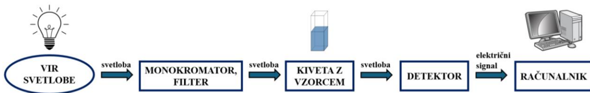
Slika 15: Poenostavljen princip delovanja UV-Vis spektrofotometra
