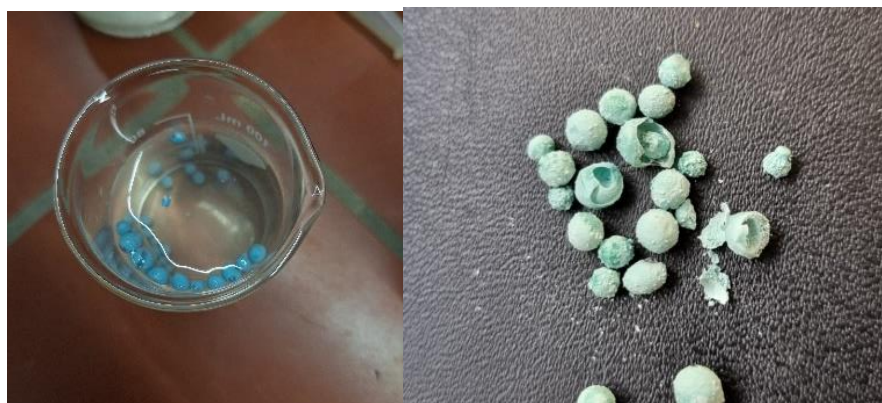
Slika 6: Sferifikacija NICS-22 z alginatom v kopeli \text{CaCl}_2
