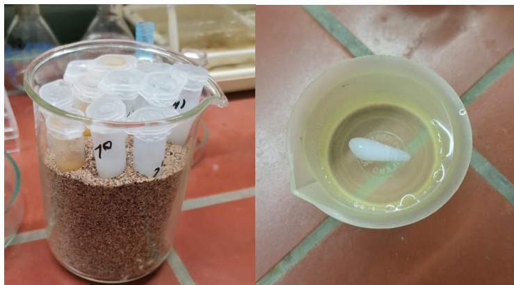
Slika 7: Peščena kopel in monolit ZIF-8 v kopeli \text{CaCl}_2
