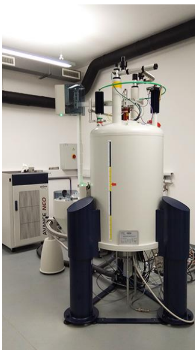
Slika 6: 600 MHz NMR spektrometer, postavljen na Nacionalnem centru za NMR spektroskopijo visoke ločljivosti na Kemijskem inštitutu v Ljubljani. Uporabljajo ga za strukturne študije in študije dinamike proteinov, DNK/RNK molekul, kompleksov proteinov in nukleinskih kislin ter majhnih molekul.
