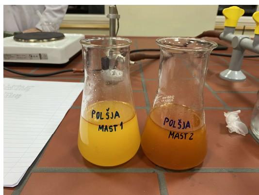
Slika 23: Paralelki polhove masti 2023 po prekinitvi reakcije pred titracijo
