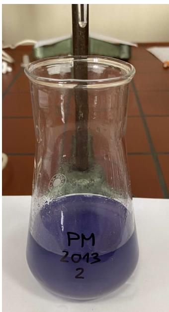
Slika 25: Raztopina vzorca (polhova mast 2013) med titracijo po dodatku indikatorja škrobovice
