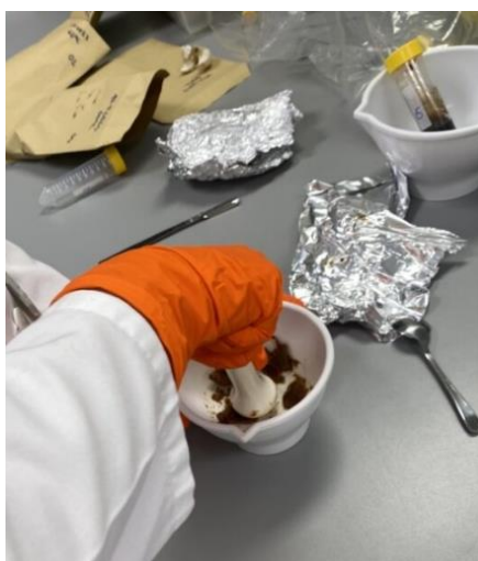
Slika 20: priprava vodnih ekstraktov
