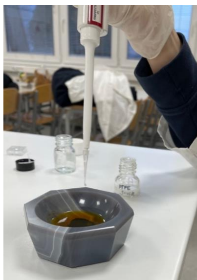
Slika 17: Mešanje sestavin za pripravo katod 1
