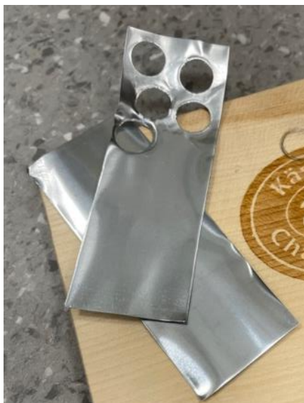
Slika 16: Rezanje cinkovih anod
