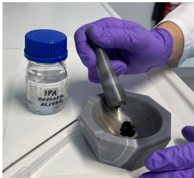
Slika 19: Zgoščen aktivni material
