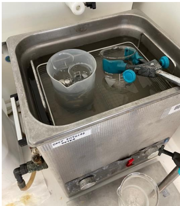
Slika 32: Čiščenje delov celic v ultrazvočni kopeli
