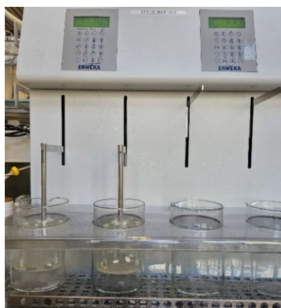
Slika 21: Naprava za ugotavljanje razpadnosti Erweka
