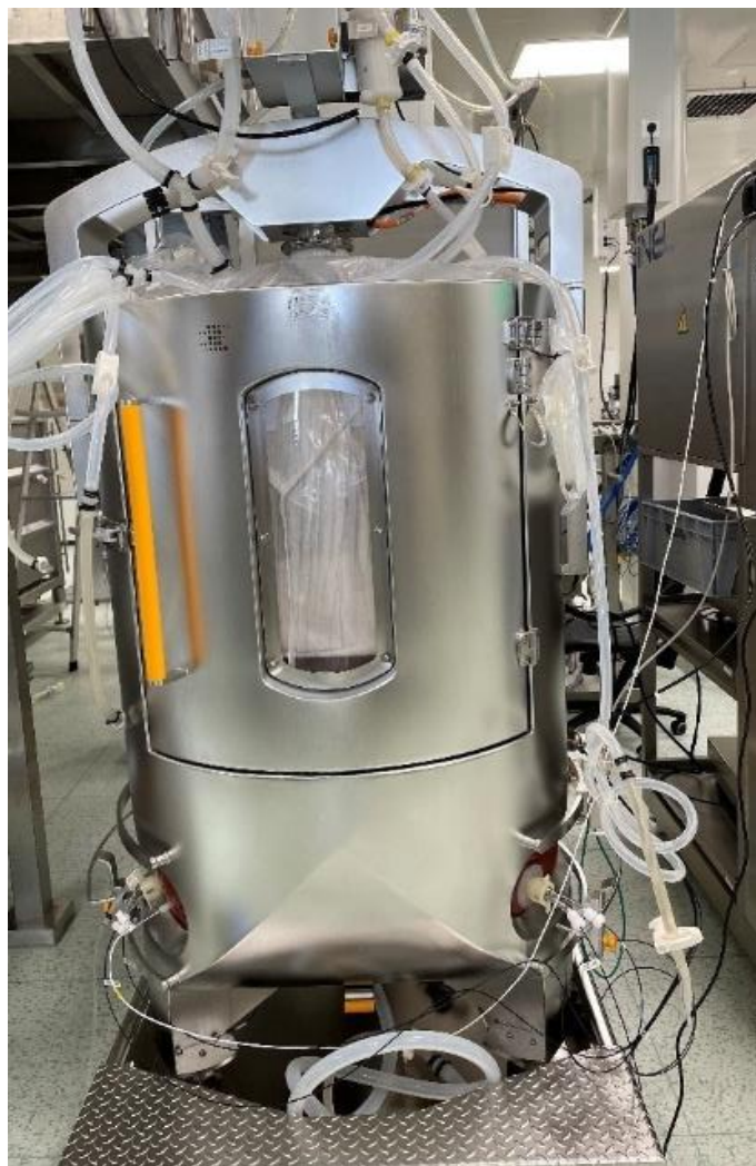
Slika 6: Bioreaktor in njegovi sestavni deli v proizvodnji bioloških učinkovin (fotografija iz proizvodnje)
