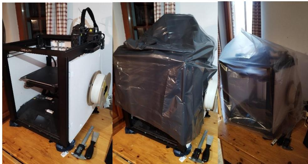
Slika 21: Rešitev za tiskanje z odprtим 3D-tiskalnikom
