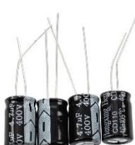
Slika 6: Kondenzatorji elektroliti
