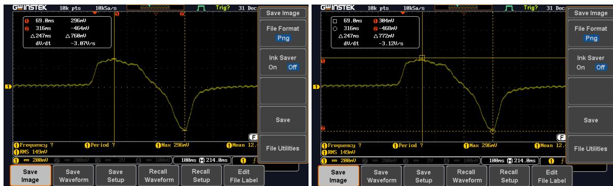
Slika 38: dolžina signala od najvišje do najnižje točke 247ms
