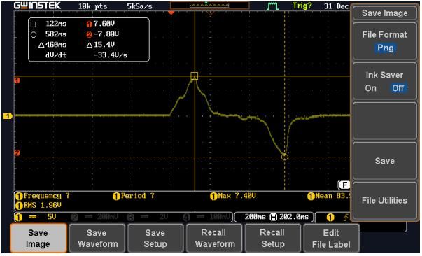
Slika 55: celotna oddana napetost 14,8V
