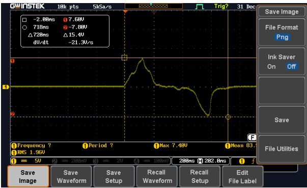
Slika 53: dolžina celotnega signala 720ms
