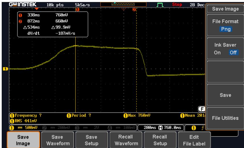
Slika 23: dolžina signala od najvišje do najnižje točke 534ms
