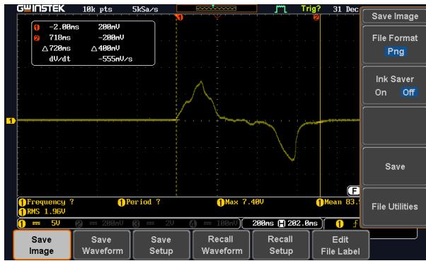
Slika 52: dolžina celotnega signala 720ms
