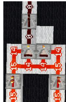
Slika 19: logična vrata XOR s komparatorji in dvema prižganima signaloma va vhodu
