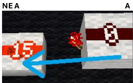
Slika 4: logična vrata NE s prižganim izhodom
