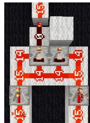
Slika 22: logična vrata XNOR z dvema prižganima signaloma na vhodu
