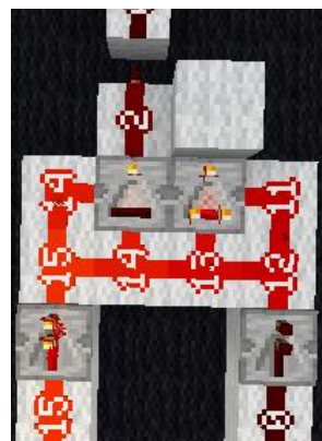
Slika 21: logična vrata XNOR z enim prižganim signalom na vhodu
