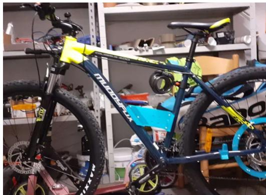
**Slika 4.4:** Nosilec za motor viden v okvirju v modrem (Avtor: Lan Koglot)
