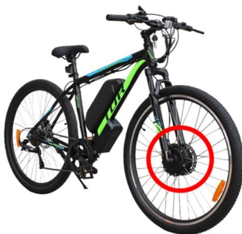
Slika 2.5: Primer kolesa z motorjem nameščenim v sprednjem pestu [6]
