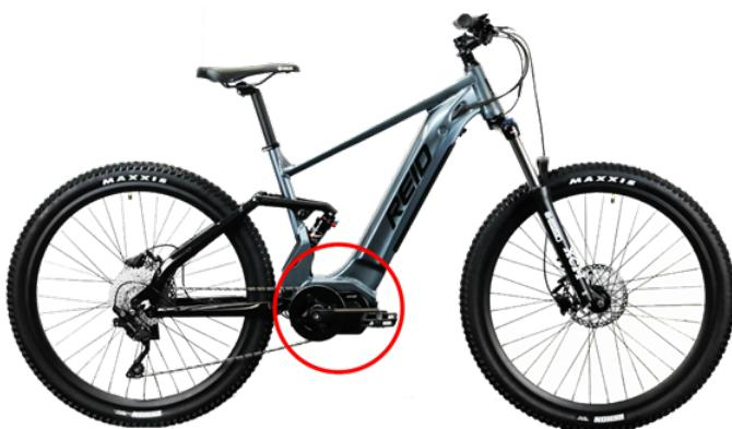
Slika 2.4: Primer kolesa z motorjem kot del pogonskega sklopa na sredini okvirja [5]
