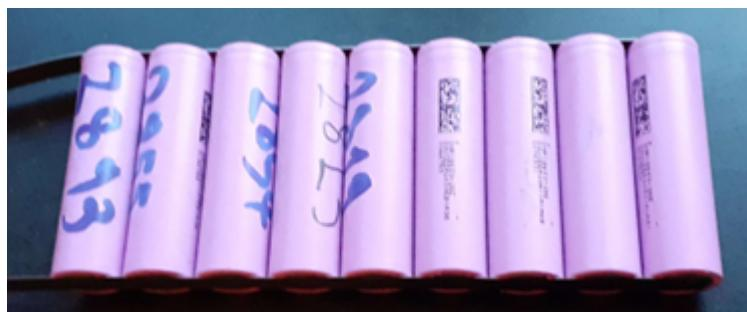
Slika 4.12: Sklop 9 vzporedno vezanih baterij (Avtor: Lan Koglot)
