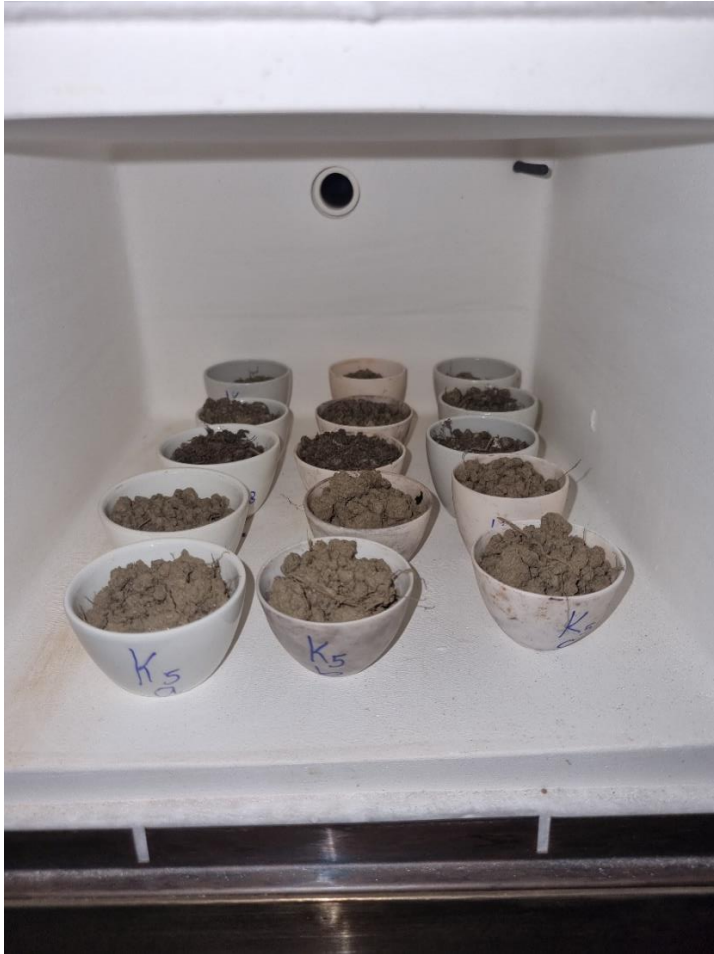
Slika V: Žarilni lončki s prstjo v peči (lasten vir).
