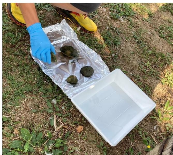
*Slika 27: Priprava kamnov za vzorčenje biofilma*
