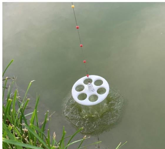
Slika 14: Secchijeva plošča
