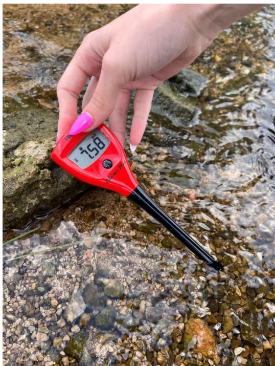
Slika 33: Merjenje pH vode z elektronskim merilcem v strugi Stržen
