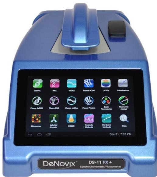
*Slika 7: Laboratorijska naprava DeNovix za merjenje koncentracije DNA z metodama spektrofotometrije in fluorometrije*
