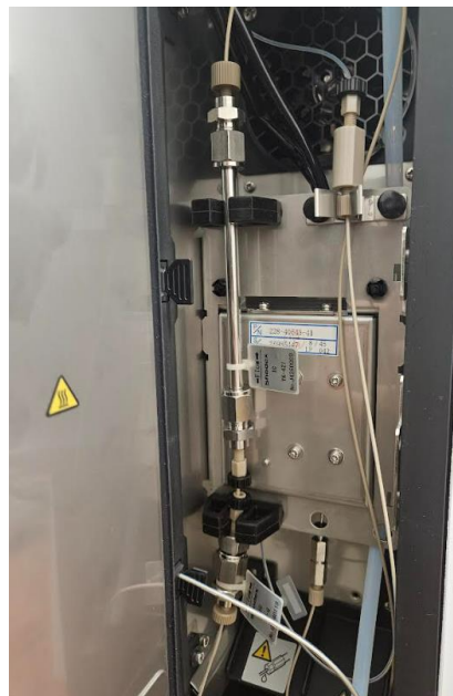
Slika 13: Pečica IC s predkolono in kolono.
