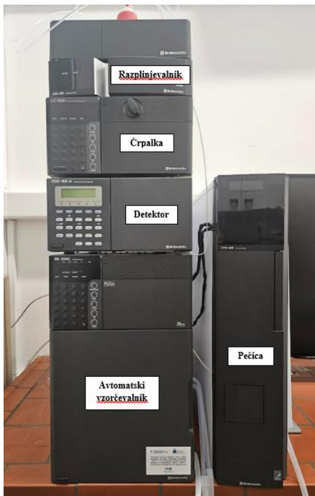
Slika 13: Pečica IC s predkolono in kolono.
