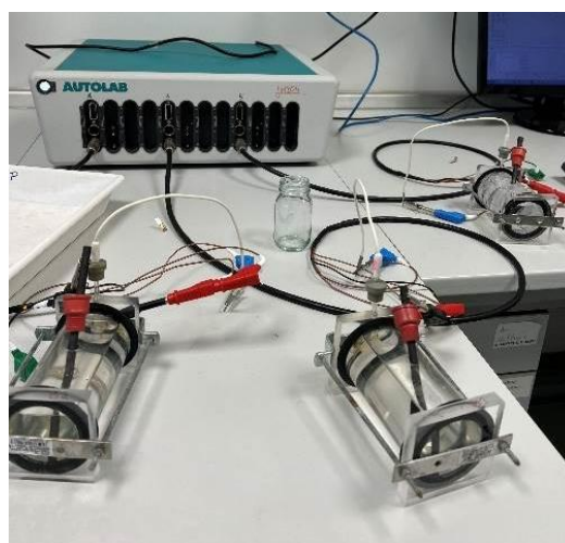
Slika 22. Sistem za elektrokemijsko testiranje materialov.
