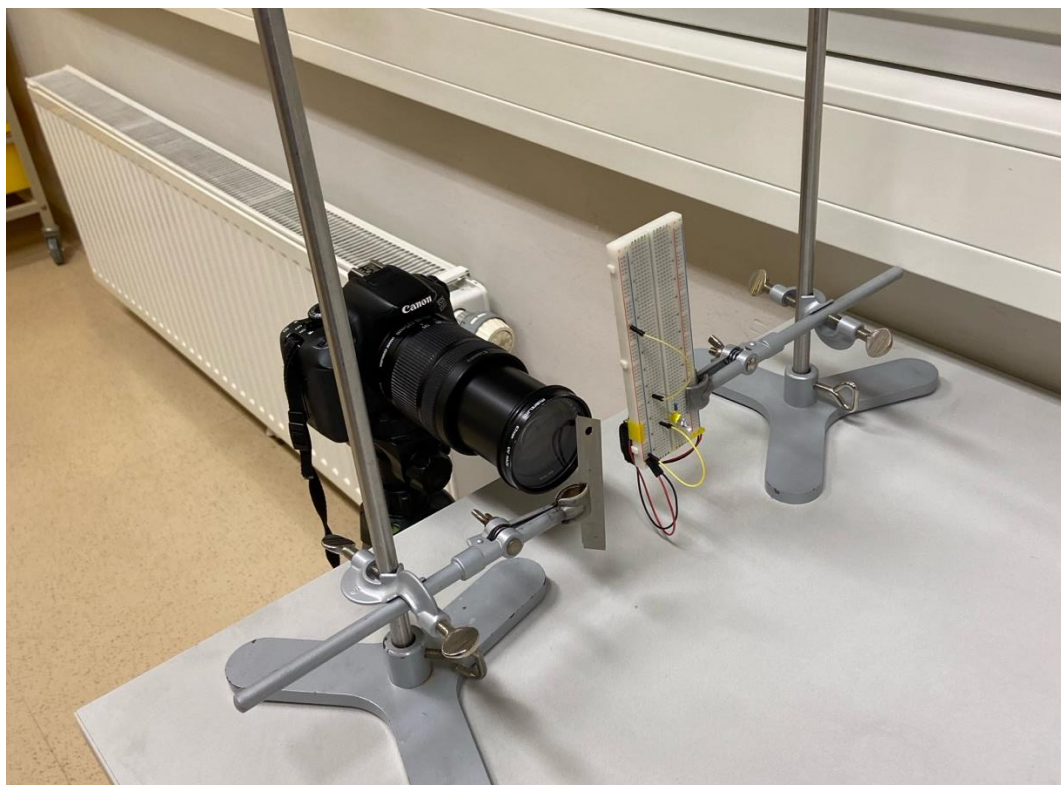
Slika 8: Postavitev rezila in LED-diode pred kamero
