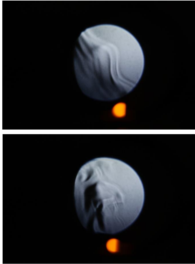
Slika 11 in 12: Pot toka toplega zraka pod vplivom pihanja
