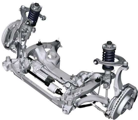
Slika 7: Primer vzmetenja z dvojnimi prečkami
