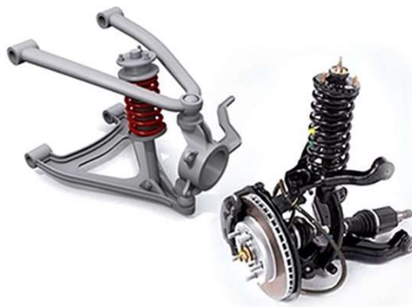
Slika 6: Primer vzmetenja z dvojnima nosilcema
