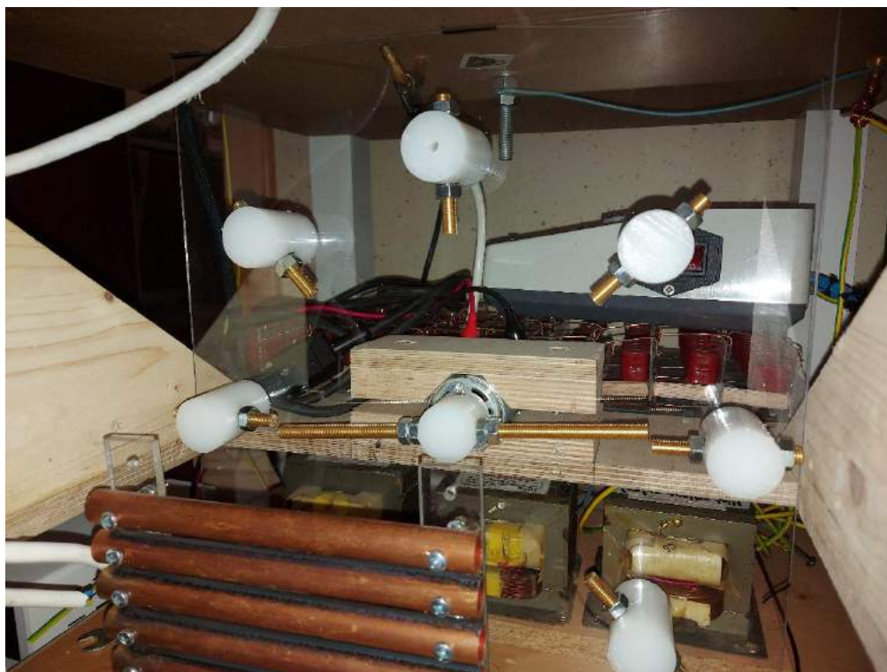
Slika 27: Propeler RSG med procesom izdelave še z nepovezanimi elektrodami.
