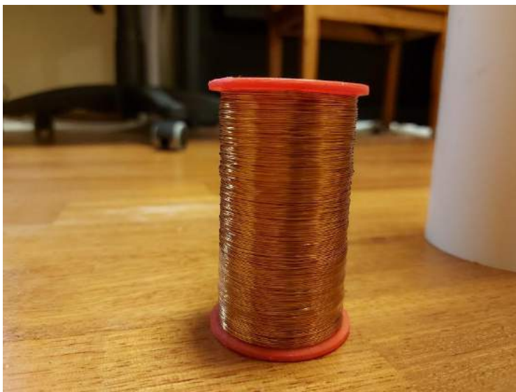
Slika 10: Bakrena žica s presekom 0,4 mm.
