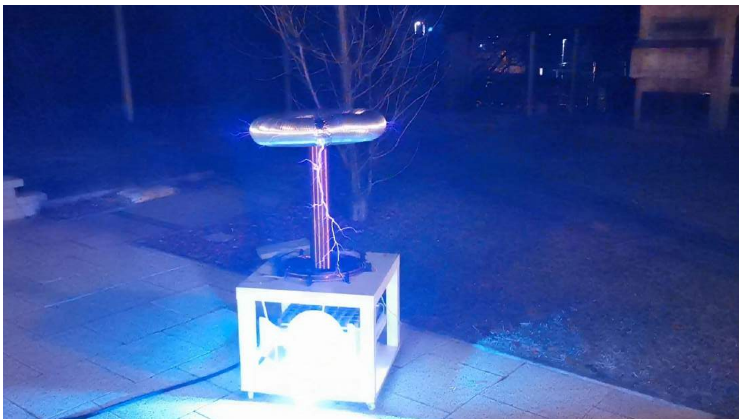
Slika 53: Prva največja strela, ki se je sprožila med prvimi testi, pri čemer je vidno intenzivno sevanje ultravijolične (UV) svetlobe iz zaščitnega iskrišča.
