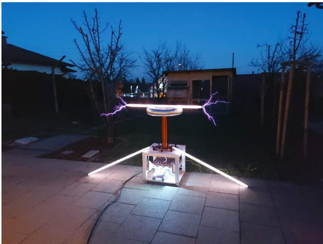
Slika 45: Demonstracija brezžičnega prenosa energije na fluorescentne sijalke in energijskega prenosa skozi fluorescentno sijalko na vrhu toroida.
