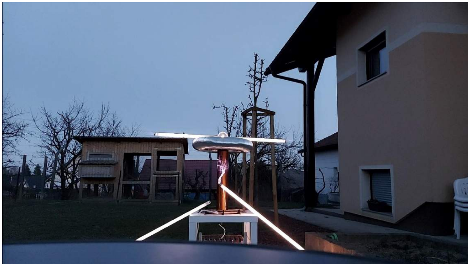
Slika 51: Strela, ki izvira iz preblizu nameščene fluorescentne svetilke, povzroča škodo na sekundarni tuljavi.
