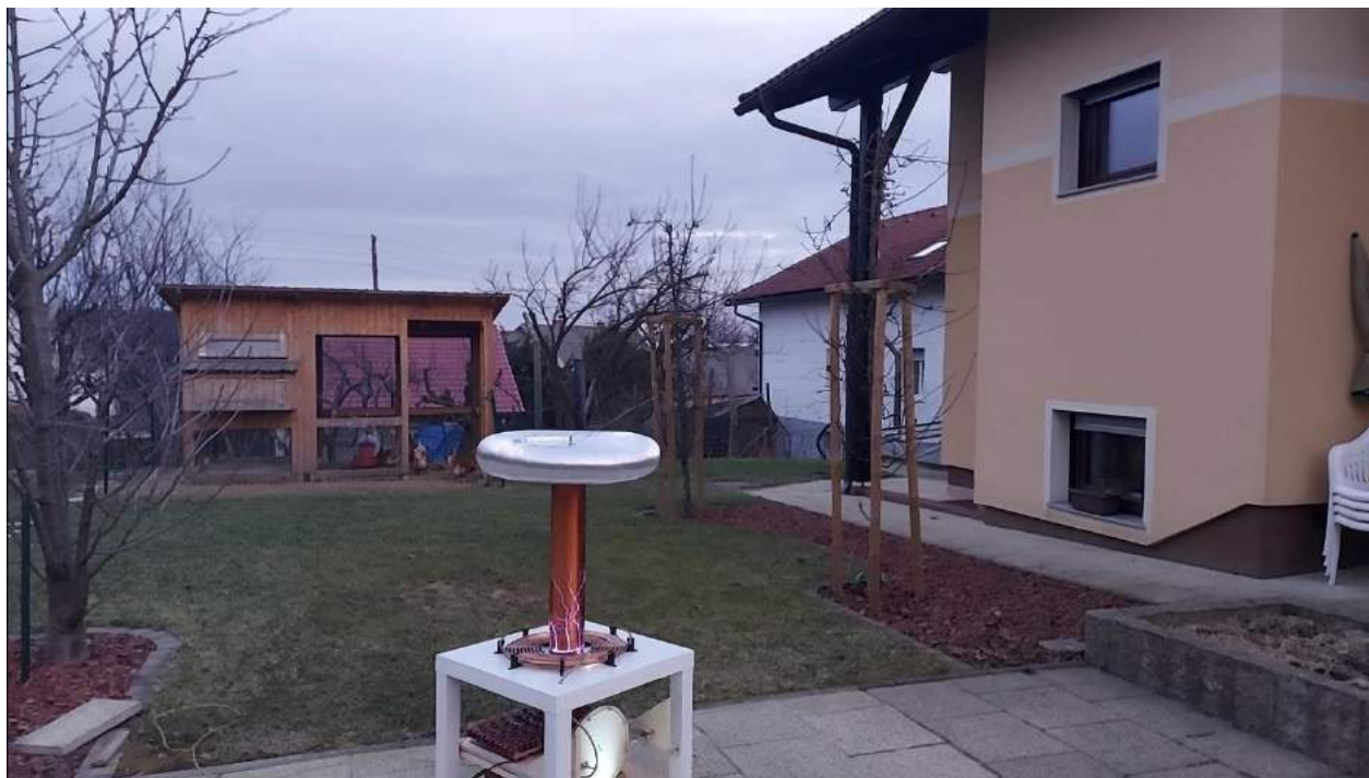
Slika 32: Neozemljena sekundarna tuljava proizvaja škodljive strele v dnu sekundarne tuljave.
