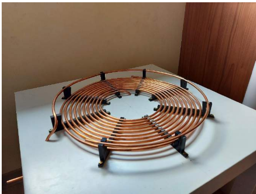
Slika 19: Dokončana primarna tuljava z udarno tračnico.
